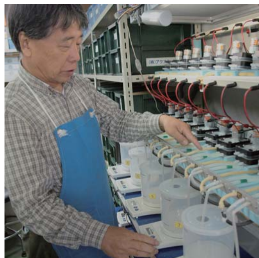
左／製造したチューブポンプが支障ないかチェックを行っている様子 左上・左下／チューブの形態
