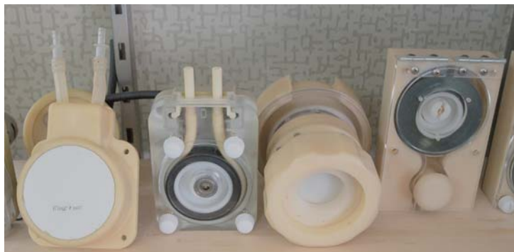
左／2種類の送液が可能なダブルポンプ。インクジェットプリンターや洗剤供給装置全般に使われている。下／社内に展示している様々なチューブポンプ。
